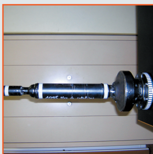
1. Vib360 permet de qualifier d'une manière précise le comportement dynamique torsionnel de la ligne de transmission d'un banc d'essai, à partir signaux de mesures issus des cibles sous forme de mire.
