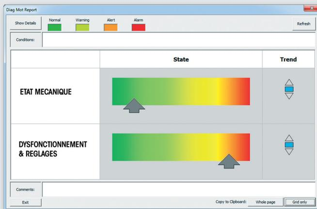
Si besoin VIB360 génère automatiquement un indicateur d'état de fatigue et de dommages. (Ici VIB360 met en évidence l'état d'un moteur V12 d'un bateau)
